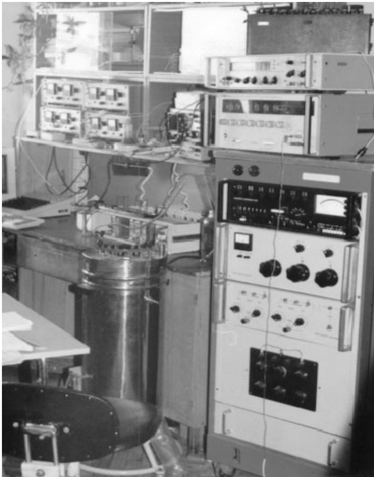
Рис. 3. Комп'ютеризований комплекс для дослідження електрофізичних властивостей матеріалів та градування і верифікації засобів вимірювання температури
