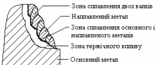
Рис.1. Загальний вигляд поверхні гребня вагонного колеса після наплавлення.
