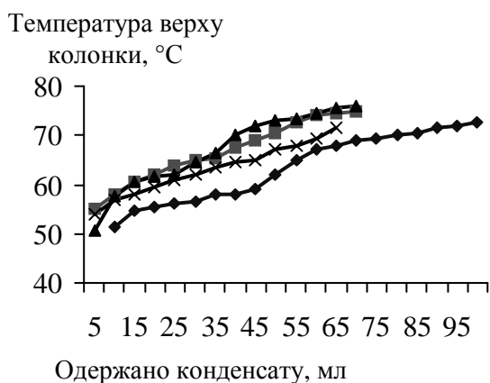
Рис. 5. Температурний режим азеотропної перегонки ефір-альдегідної фракції і бензину
