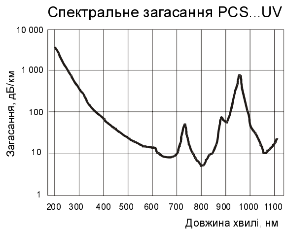
Рис. 2. Спектральна характеристика загасання використовуваного світловоду
