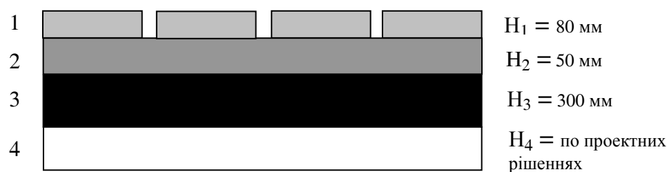
Рис.2. Конструктивне рішення з влаштування міських доріг.
