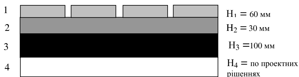
Рис.1 Конструктивні рішення з влаштування тротуарів.
