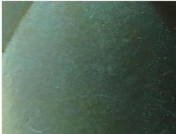
Оксидное покрытие модифицированное таннином, полученное вибрационным способом после 685 часов коррозионных испытаний в 3%-ном растворе хлорида натрия. Материал образцов АДО
