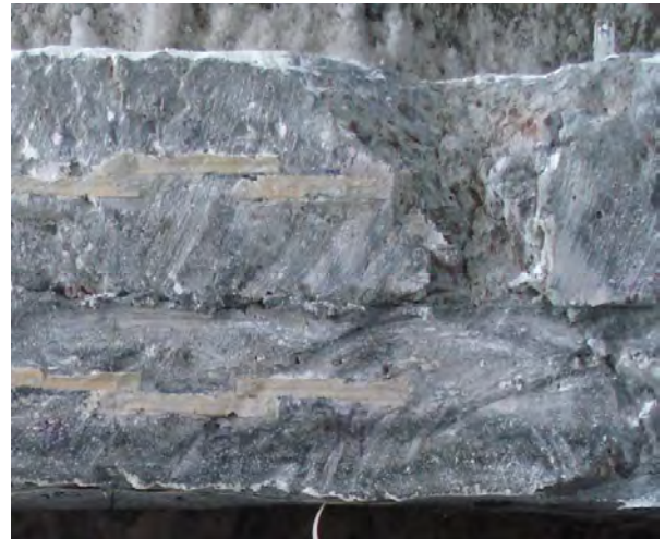
Рис.4. Характер руйнування балки Б-1-1-1пт у зоні максимального моменту: а – нижньої грані, б – верхньої грані
