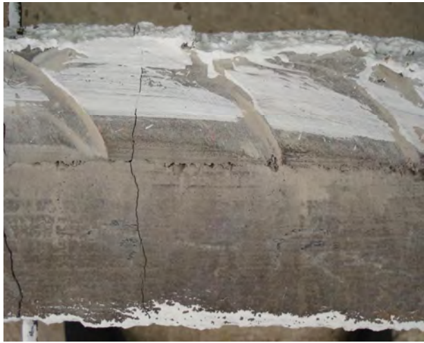
Рис.4. Характер руйнування балки Б-1-1-1пт у зоні максимального моменту: а – нижньої грані, б – верхньої грані
