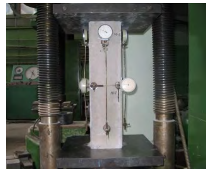
Рис. 2. Випробування для одержання модуля пружності, коефіцієнта Пуассона на гідравлічному пресі
