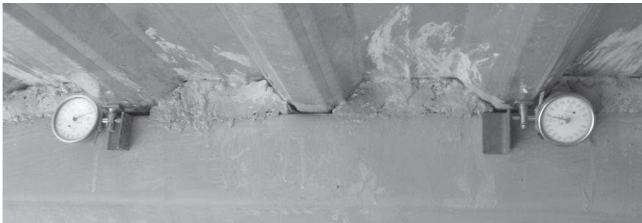
Рис. 6. Мікроіндикатори годинникового типу, встановлені для визначення зсувних зусиль у плиті
