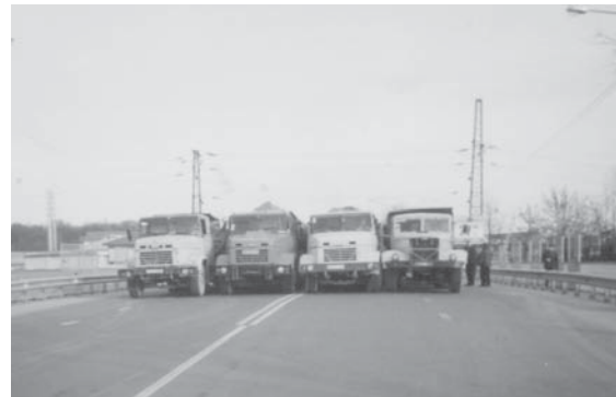
Рис. 3. Загальний вигляд випробувань прольотної будови крайнього (к) і середнього (с) прольотів
