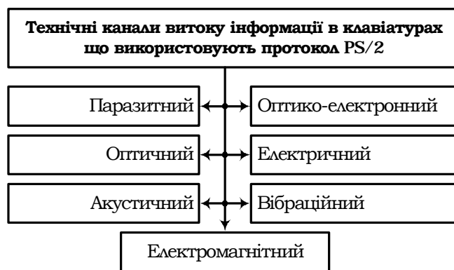
Рис. 2. Класифікація технічних каналів витоку інформації в клавіатурах, що використовують протокол PS/2
