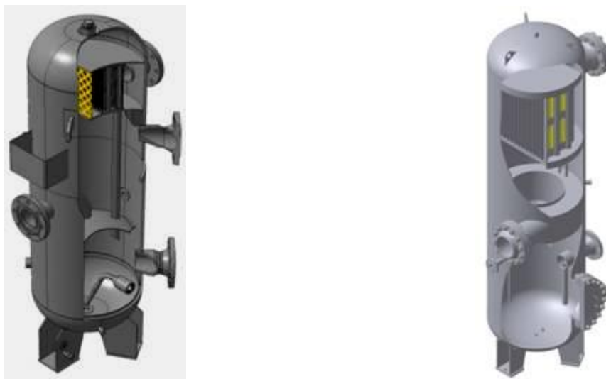
Рис. 1. Високоєфективні двоступеневі газосепаратори тонкого очищення природного газу інерційно-фільтрувального типу з відцентровими та жалюзійними елементами
