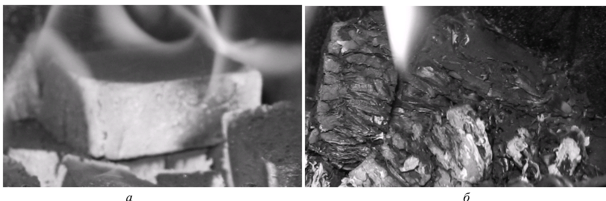
Термічна деструкція композиційного брикету: a – початкова стадія горіння; б – брикет під час горіння
