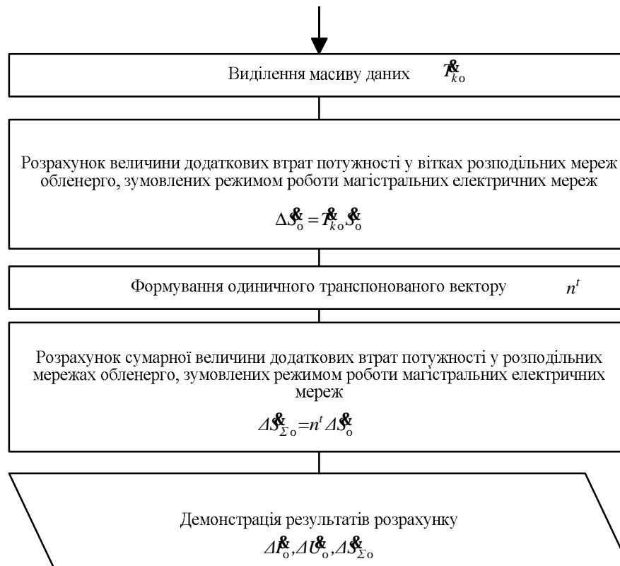
Алгоритм реалізації методу визначення величини негативного впливу магістральних електричних мереж на розподільні мережі обленерго
