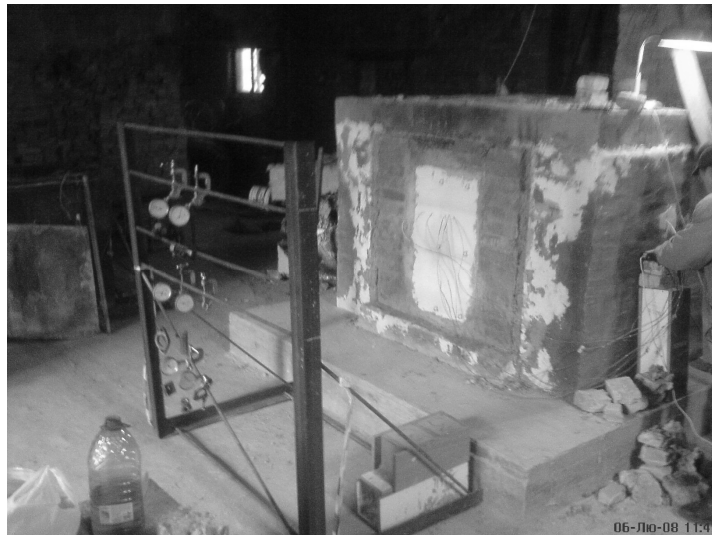
Рис. 4. Вид змонтованого зразка у печі
