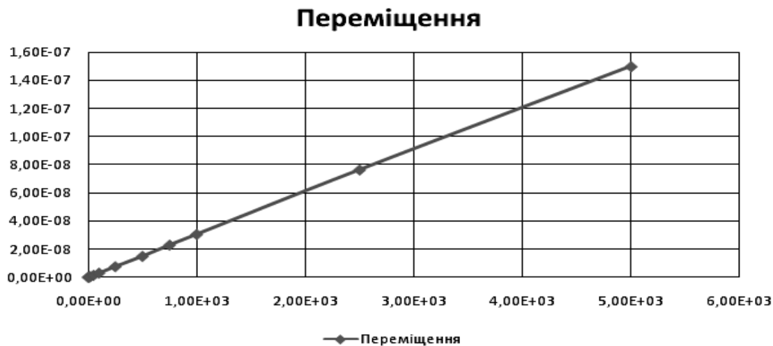
Рис. 5. Діаграма залежності переміщення чутливої маси від прискорення
