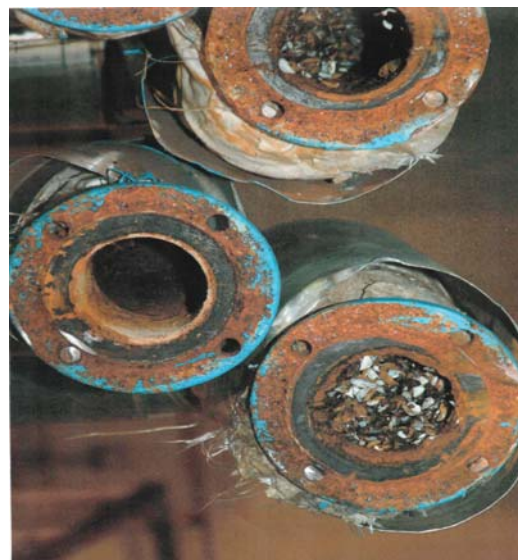
Рис. 1. Фотовигляд забруднення дрейсеною технологічного устаткування та трубопроводів технічної води електростанцій
