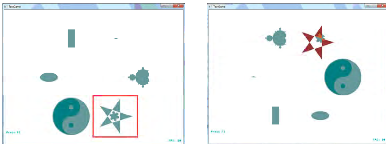
Рис. 3. Попіксельна перевірка зіткнення двох геометричних об'єктів. В одному випадку відбувається зіткнення між двома об'єктами. Один із об'єктів підсвічено червоним кольором
