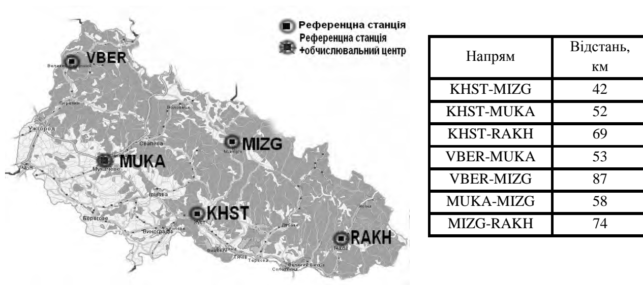
Рис. 1. Схема розташування референцних станцій мережі ZAKPOS та відстані між ними
