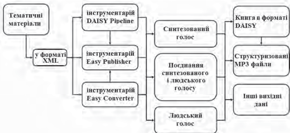
Рис. 4. Виробничі процеси створення книжки, що “розмовляє”
