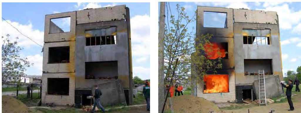
Рис. 1. Фрагмент будівлі перед та після випробування
