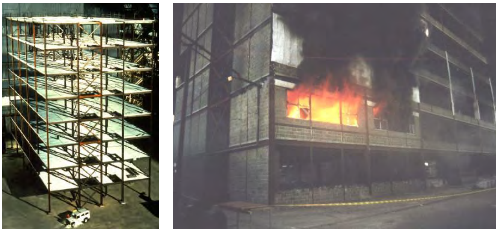
Рис. 3. Загальний вигляд каркаса (а) та пожежений відсік під час випробувань “British Steel Test 4”: пожежа в офісі (б) [9]
