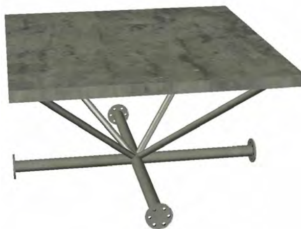
Рис. 2. Окремий елемент збірної сталезалізобетонної конструкції – «кристал»
