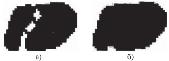
Figure 5.: a) input image; b) image «closure»
