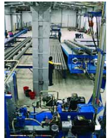
Новий підрозділ компанії «Ельпласт» — завод з виробництва попередньоізольованих труб та фасонних частин для мереж теплопостачання
