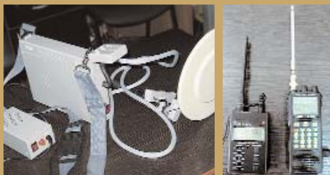
Нелінійний локатор «КАТРАН» та скануючий приймач AR8200
