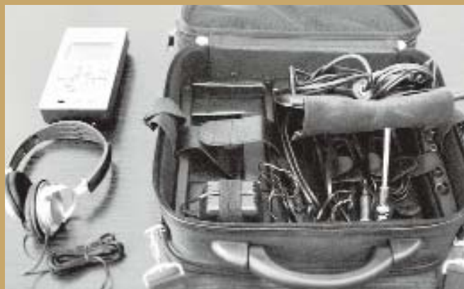
Багатофункціональний пошуковий пристрій ST 031P «Пиранья»
