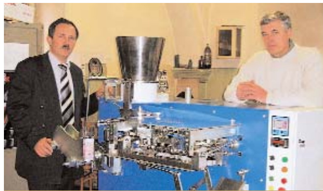
Одна з розробок кафедри — автомат пакування ситких продуктів (розробники — справа наліво: С. В. Яхимович і В. М. Боровець)
