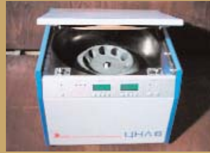
Медична центрифуга для сепарування крові з вентильним приводом
