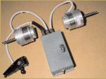
Електропривод коліс інвалідного візка на базі вентильних двигунів
