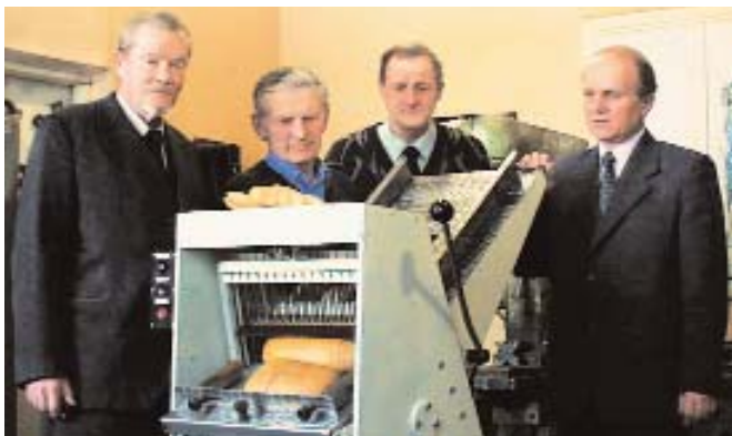
Одна з перших розроблених кафедрою машин для різання хлібобулочних виробів і представники розробників, справа наліво: З. А. Стоцько, А. Р. Завербний, М. І. Кушнір, Ю. В. Кодра
