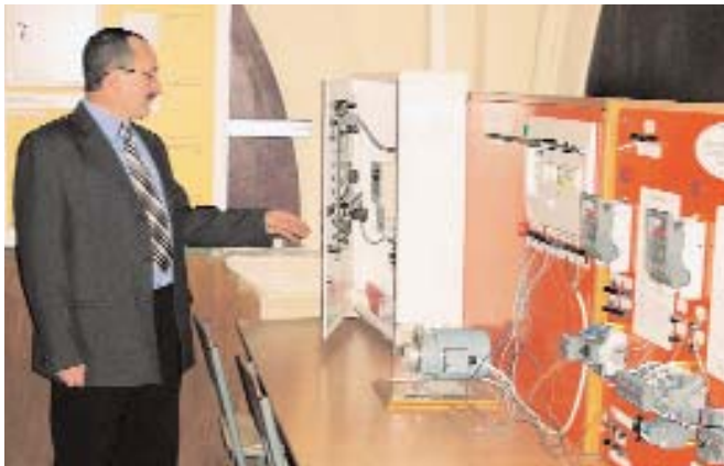
Дослідження систем пуску асинхронних двигунів фірми АВВ
