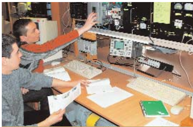
Стенд для дослідження мікропроцесорної системи керування електроприводами насосної станції
