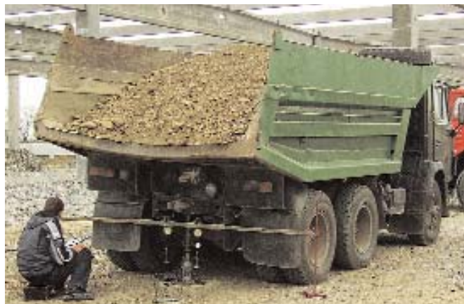
Натурні експериментальні дослідження штучної основи, підготовленої під покриття підлоги торгового центру «Арсен» (м. Стрий Львівської області)
