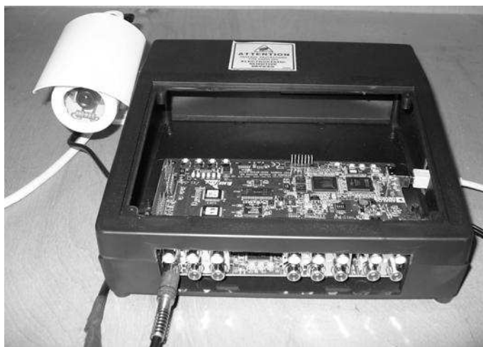
Рис. 4. ADSP-BF533 EZ-KIT Lite з під'єднаною відеокамерою
