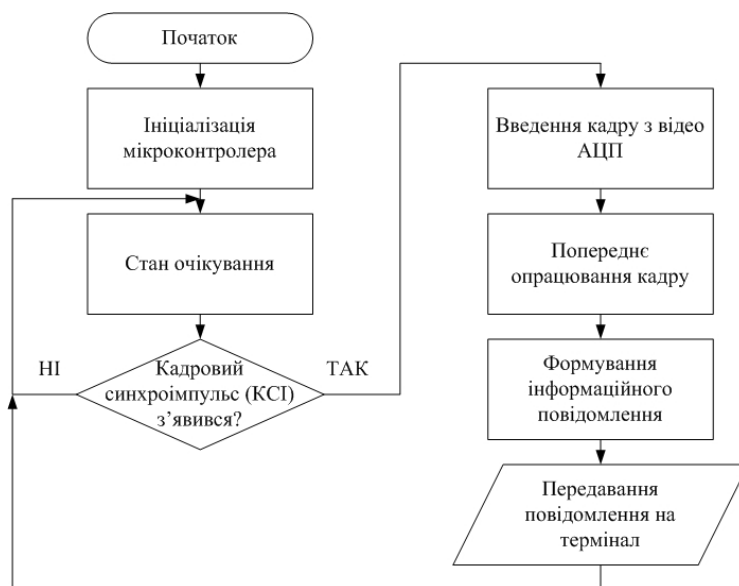
Рис. 3. Блок-схема алгоритму функціонування підсистеми на базі мікроконтролера MC56F8367
