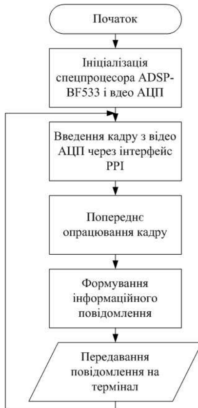
Рис. 5. Блок-схема алгоритму функціонування підсистеми на базі ADSP-BF533
