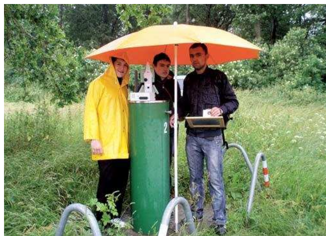
Студенти на метрологічній атестації тахеометра TCR 1203 ++ Leica Geosystems на геодезичному базисі "Ganzkow"
