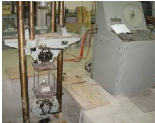
Рис. 2. Загальний вигляд дослідження зчеплення арматури з бетоном на розривній машині УММ-50
