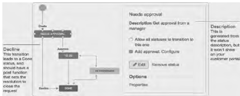
Рис. 2. Робочий процес життєвого циклу запиту в Jira
