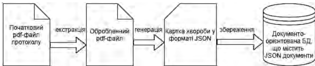
Рис. 2. Схема обробки уніфікованого клінічного протоколу
