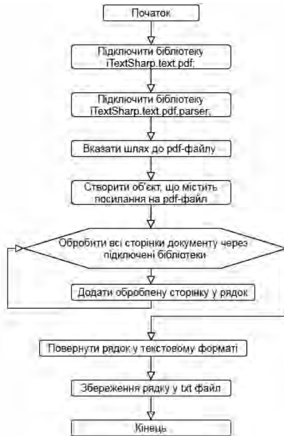
Рис. 3. Алгоритм роботи парсеру даних з медичних протоколів
