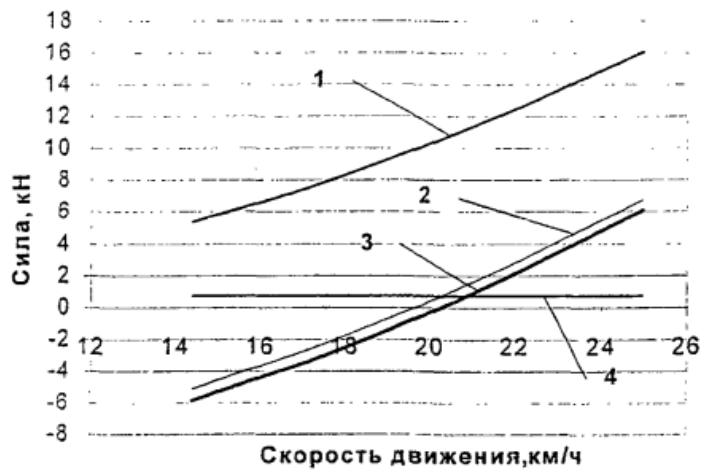
Рисунок 1.4 – Залежність необхідних зусиль на ЗП від швидкості руху (для радіуса повороту 15 м) [89]: 1 – сила інерції; 2 – необхідне тягове зусилля на ЗП; 3 – необхідне додаткове зусилля; 4 – сила опору руху причепів
