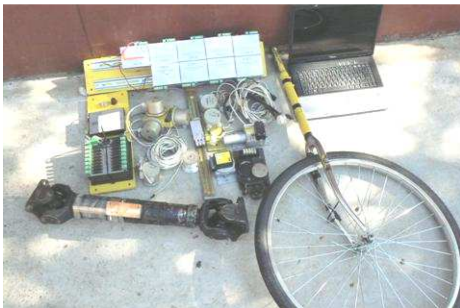
Рисунок 4.4 – Вимірювальний комплекс апаратури для визначення характеристик транспортних засобів: 1 – вимірювальний комплекс із програмним забезпеченням на базі ноутбука; 2 – модуль ЦАП-ЦАП з гальванічною розв’язкою, каналами цифрового введення – виведення; 3 – модем дистанційного передавання даних; 4 – карданний вал із тензомостом та інформаційним передавальним модулем; 5 – тахометр із датчиком обертів маховика; 6 – плата швидкості руху і переміщення; 7 – витратомір палива; 8 – вібродатчики; 9 – датчик лінійних переміщень; 10 – “п’яте” колесо із герконовим датчиком обертів; 11 – блоки живлення датчиків; 12 – акселерометр
