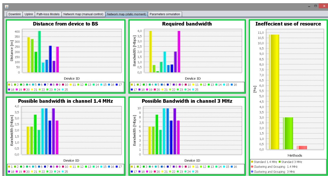
Рис. 3.25. Вимоги по необхідній швидкості передавання мобільних пристроїв та М2М датчиків при дослідженні можливостей забезпечення якості обслуговування згідно класичної архітектури, доповненої мультистандартним шлюзом, без врахування пріоритетів сервісів
