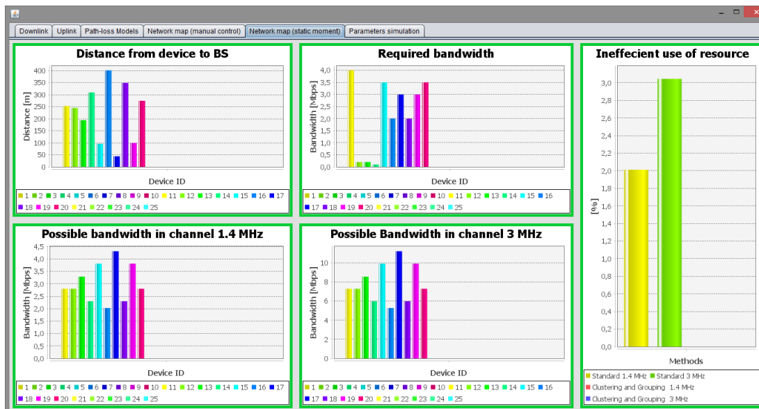
Рис. 3.27. Вимоги до пропускну здатності мобільних пристроїв та M2M датчиків при дослідженні можливості забезпечення надання сервісу без аналізу необхідної пропускну здатності при обслуговуванні згідно класичної архітектури LTE без врахування пріоритетів сервісів
