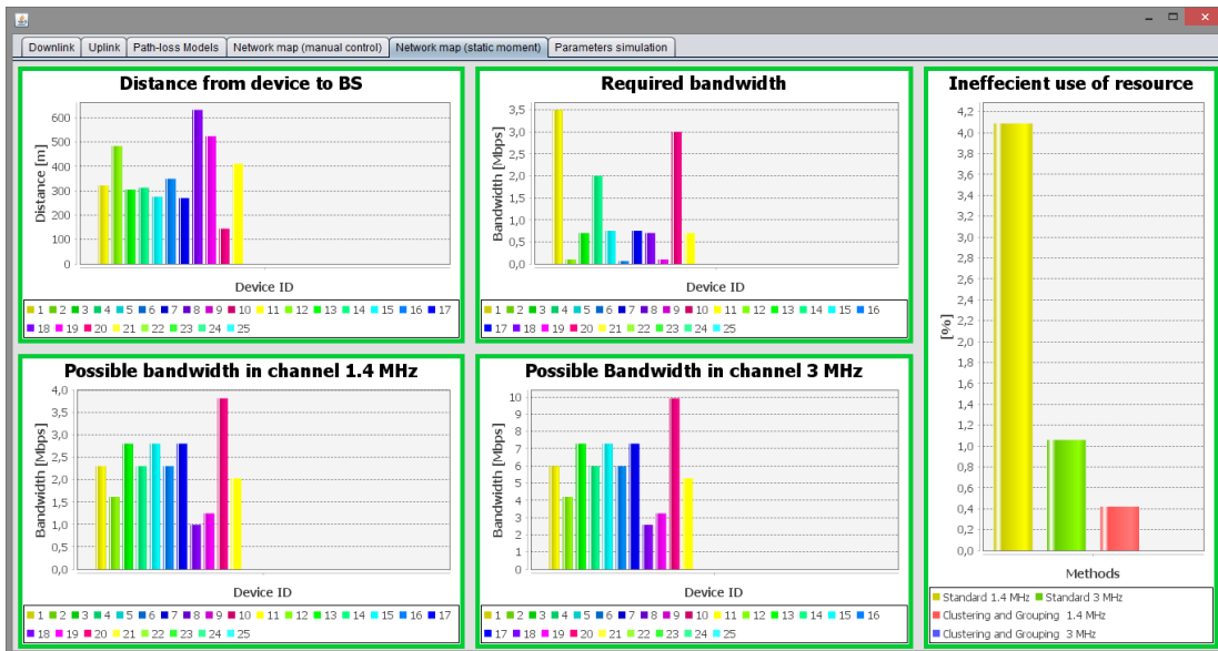
Рис. 3.35. Вимоги до пропускної здатності та неефективність використання доступних ресурсів мобільними та M2M датчиками при їх обслуговуванні класичною архітектурою LTE, доповненою мультистандартним шлюзом, без врахування детермінованих початків передавання даних
