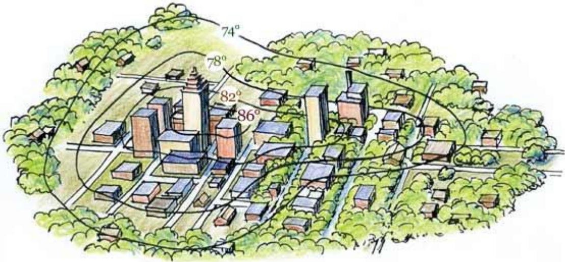
Рисунок 2.13 – Поширення острова тепла (температура зазначена в градусах Фаренгейта) [93]
