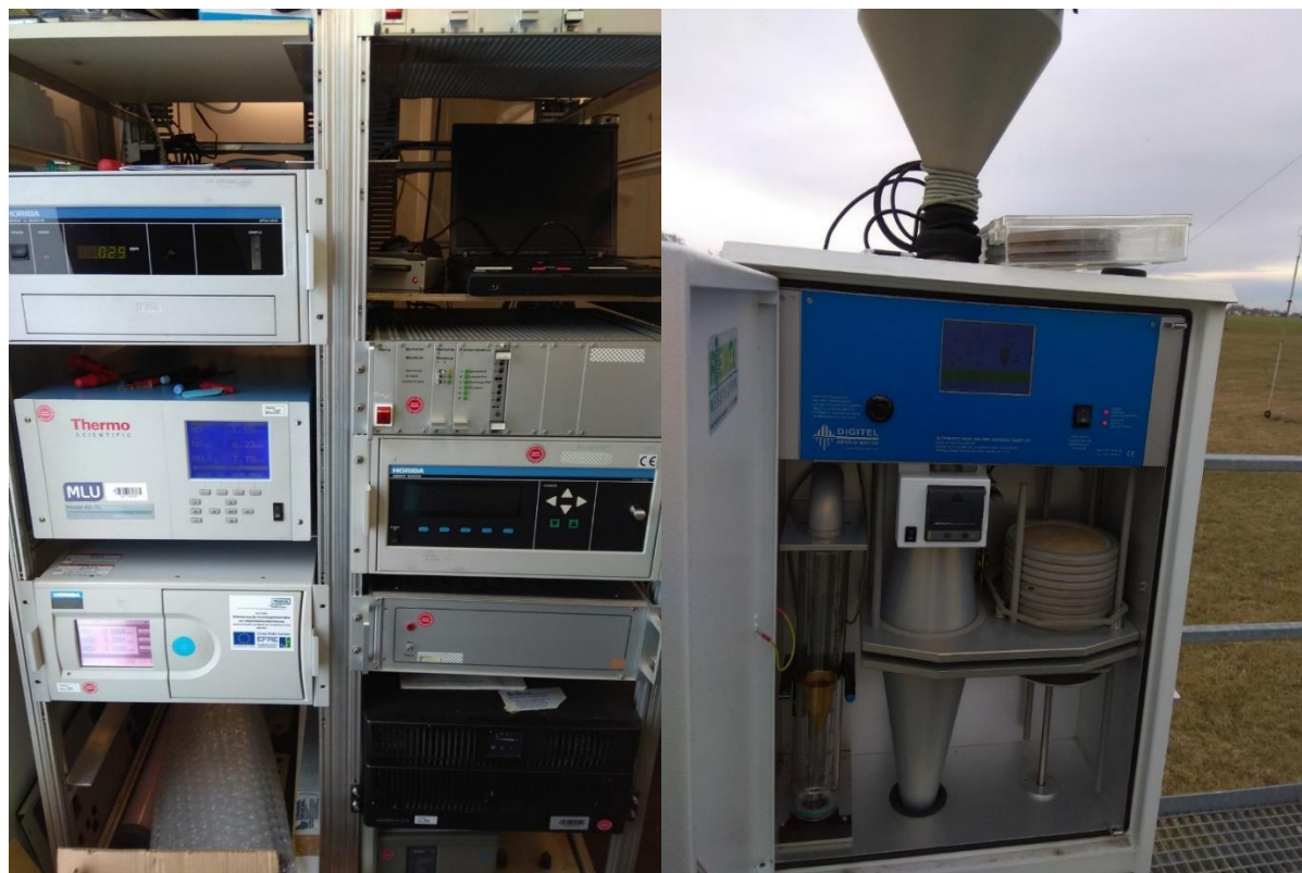
Рисунок 2.6 – Автоматизовані прилади вимірювання забруднення атмосфери повітря в м. Лейпциг
