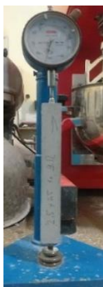
Рисунок 4.21 – Власні деформації модельних систем на основі глиноземистого цементу в повітряно-сухих умовах
