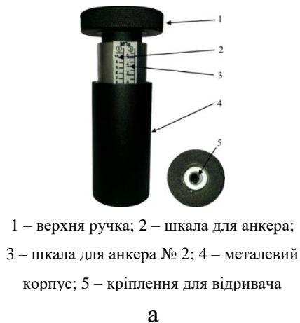
Рисунок 2.7 - Адгезиметр механічний NOVOTEST АЦ-1 (а) та визначення міцності зчеплення з основою (б)
