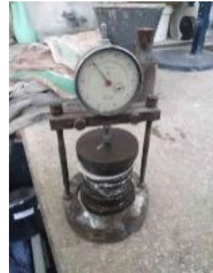
Рисунок 4.20 – Деформації розширення модельних систем на основі глиноземистого цементу
