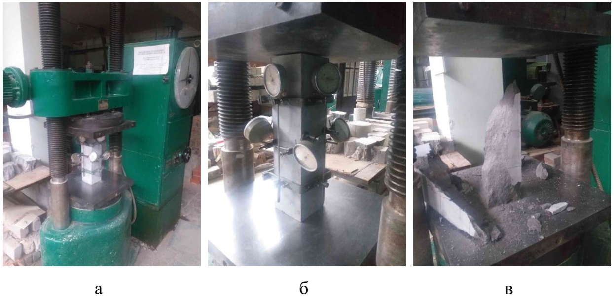
Рисунок 4.10 – Визначення показників деформативності ремонтної безусадочної суміші (а, б); визначення призмової міцності (в)
