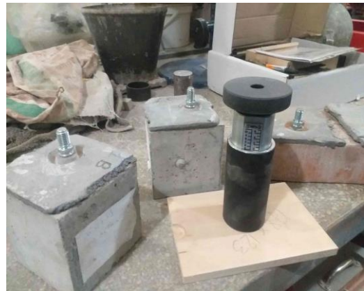
Рисунок 2.7 - Адгезиметр механічний NOVOTEST АЦ-1 (а) та визначення міцності зчеплення з основою (б)
