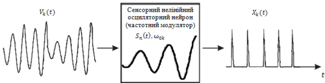
Рис. 3.2.1. Схематичне зображення процесу перетворення вхідного сигналу V_k(t) сенсорним нелінійним осциляторним нейроном (пороговим пристроєм). Часи генерації імпульсів на виході порогового пристрою X_k(t) відповідають моментам перетину порогового рівня
