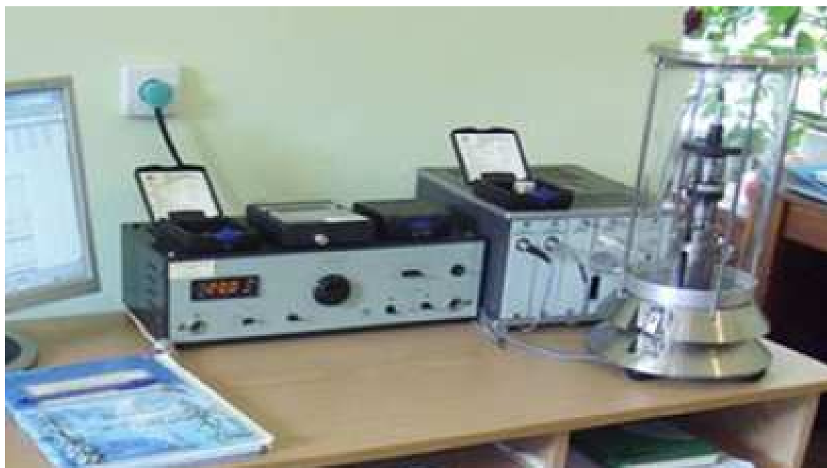
Рисунок 4.2 – Зовнішній вигляд удосконаленої еталонної установки УЕ-2ПУ ДПЕУ ОЗТ в повітряному середовищі
