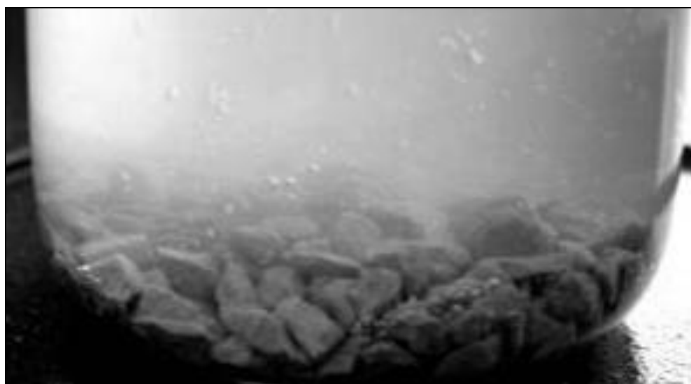
Рис. 4.11. Виділення бульбашок газу внаслідок дії УЗ-випромінювання
