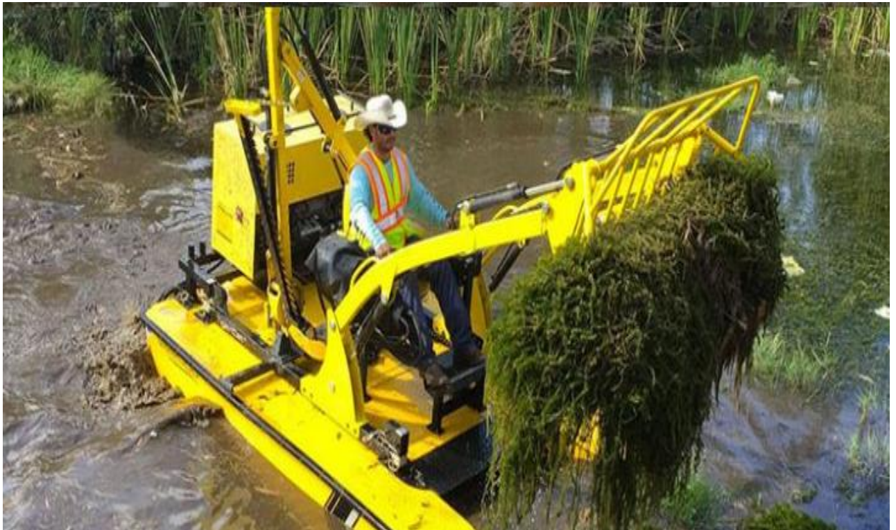
Рисунок 4.6 - Збір макроводоростей спеціалізованим водяним комбайном
