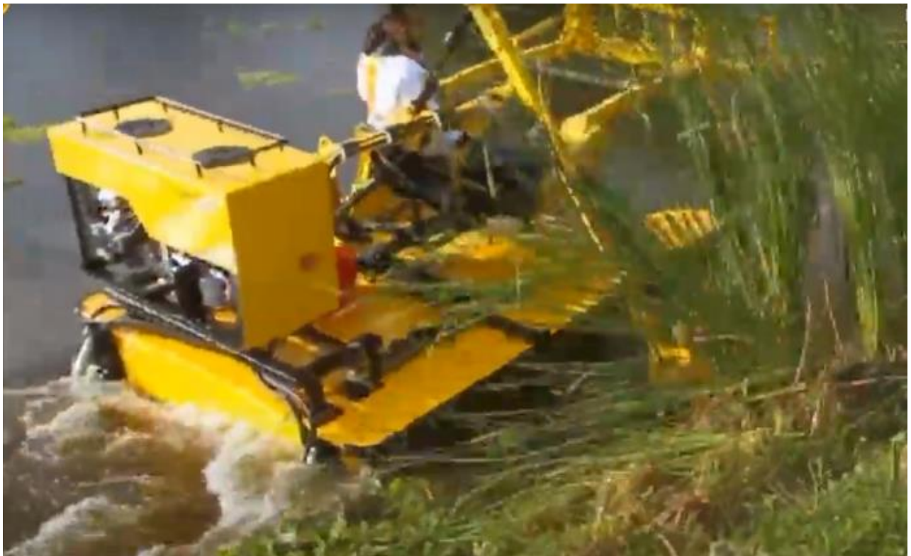
Рисунок 4.7 - Використання плавучої косарки для збору надлишкової біомаси очерету
