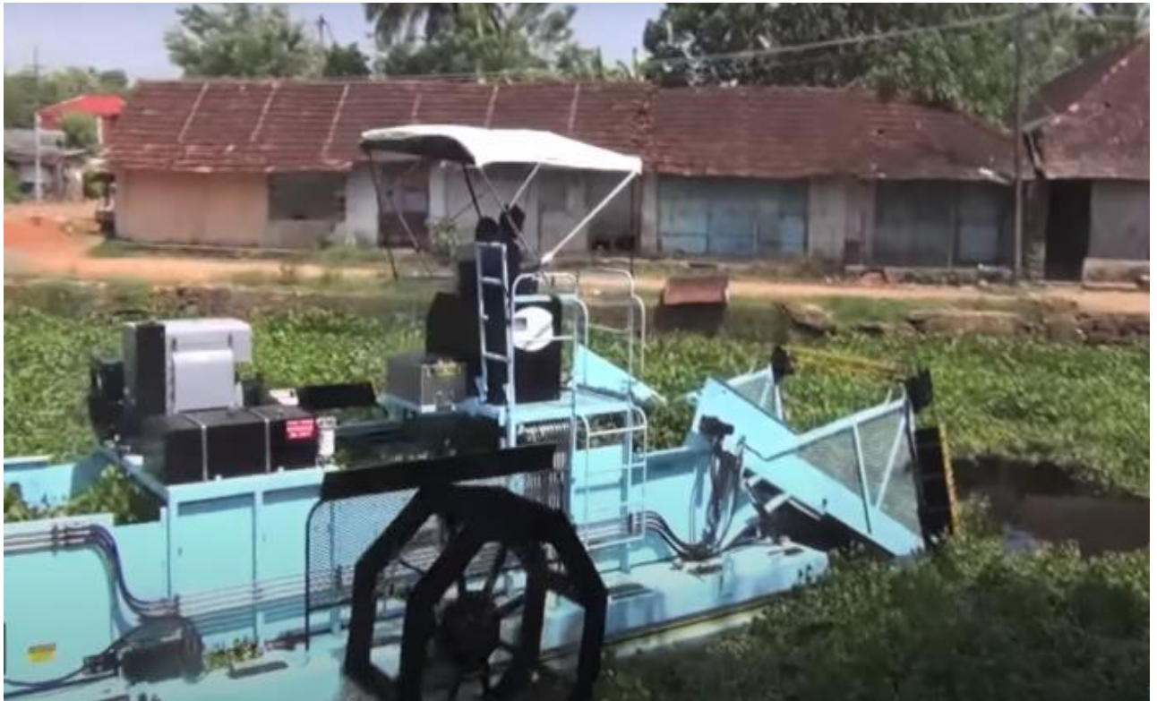
Рисунок 4.5 - Збір водяних гіацинтів спеціалізованим водяним комбайном
