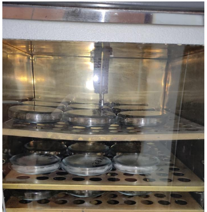
Рисунок 4.13 – Досліджувані зразки у сухоповітряному термостаті.
