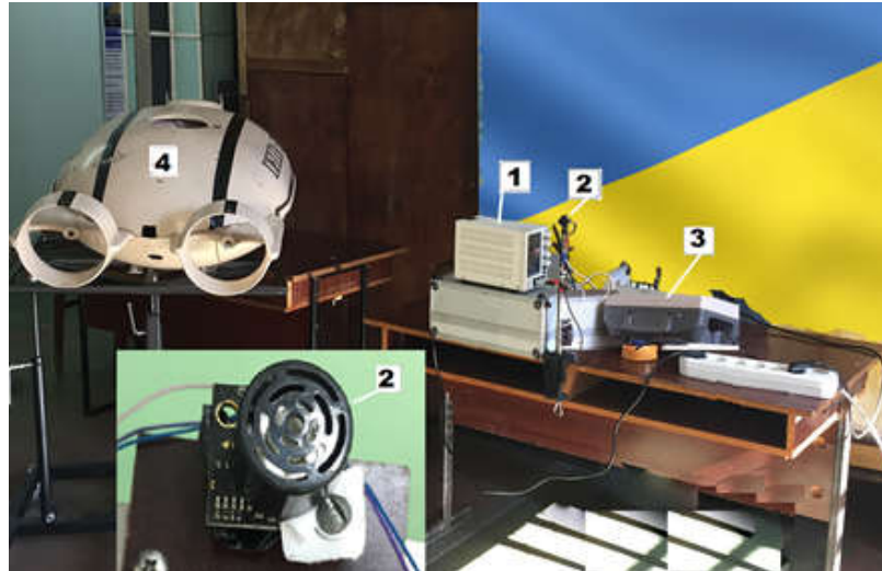
Рисунок 4.5 – Стенд для визначення діаграми спрямованості ультразвукових далекомірів: 1 – блок живлення; 2 – ультразвуковий далекомір моделі MB 1003-EZ0; 3 – осцилограф; 4 – макет АНПА-1
