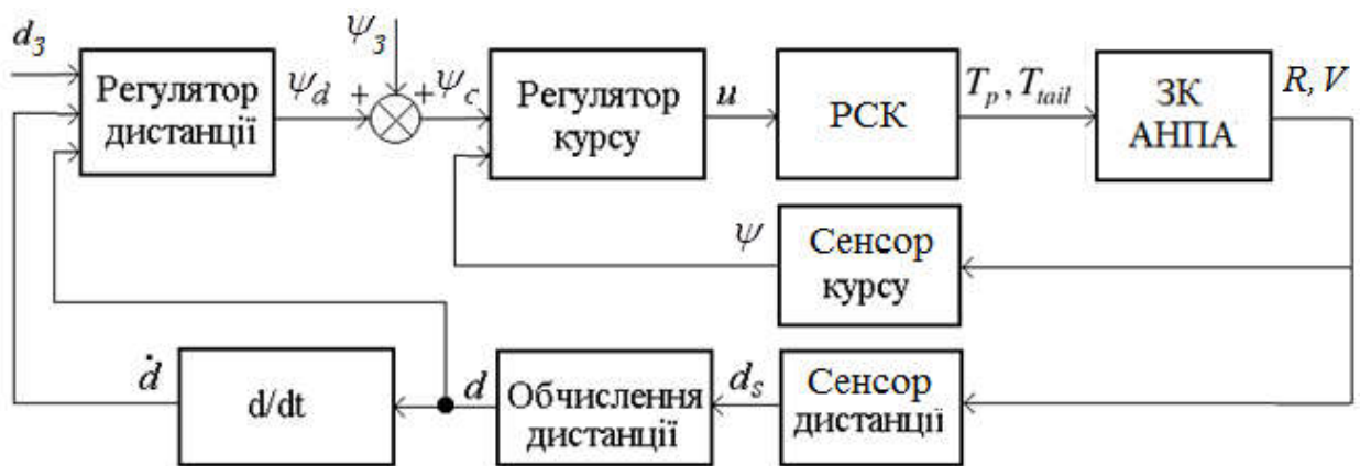
Рисунок 2.2 – Структурна схема САК рухом одиночного АНПА як «агента» групи в умовах навігаційної близькості інших АНПА
