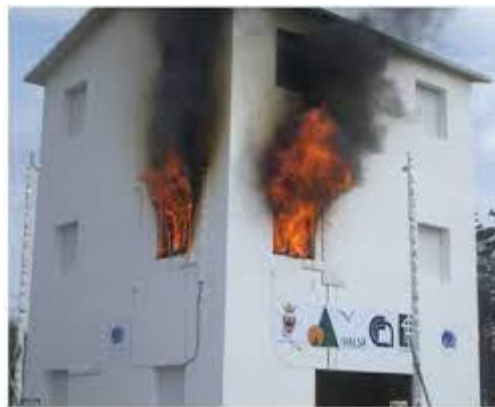
Рис.1.10. Повномасштабне натурне випробування дерев'яної споруди у Японії [48].
