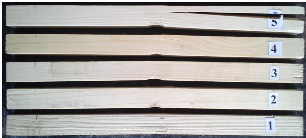
Рис. 3.3. Загальний вигляд зруйнованих зразків на згин;
