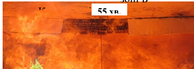
б) Обвуглювання балки на глибину 25 - 30мм в зоні Б, розриви в стиках гіпсокартонних листів
