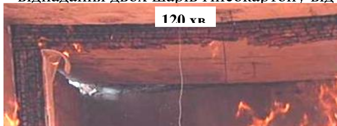
г) Обвуглювання балки на глибину більше 100 мм в зоні Б,
