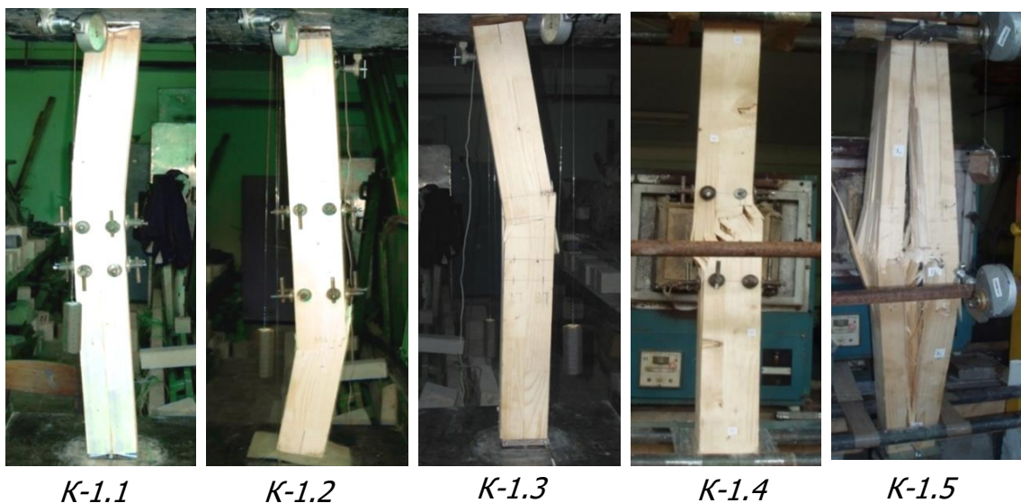
Рис. 3.4. Вигляд стиснутих дощатоклеєних колон після руйнування.
