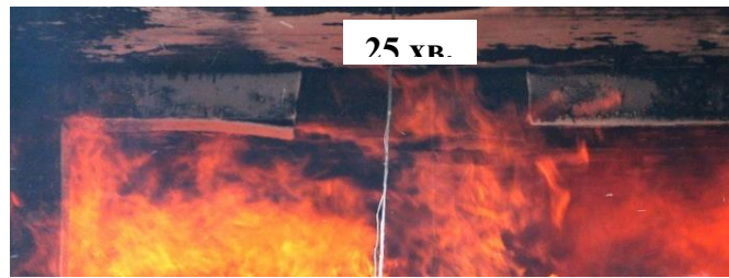
а) Початок обвуглювання та горіння деревини балки в зоні Б
