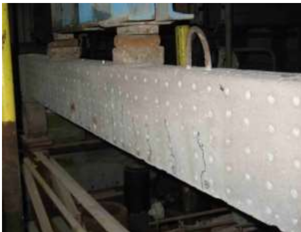
Рис.2.14. Відкриті виїмки на поверхні балок
