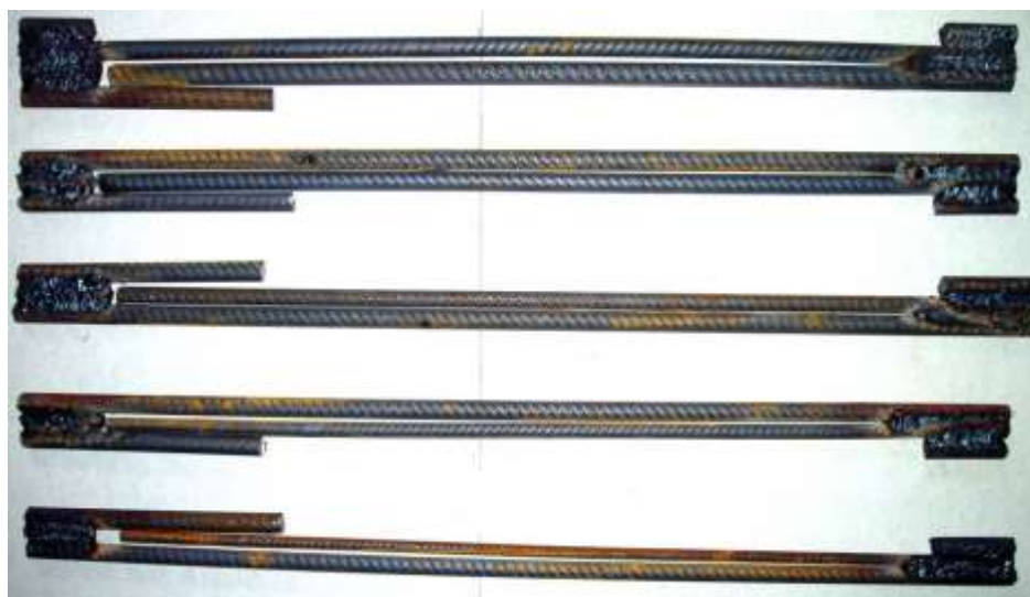
Рис. 2.3. Дослідні арматурні зразки пакетів перед випробовуванням
