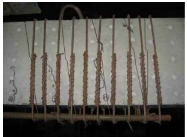
Рис. 2.15. Додаткові хомути з дроту \varnothing 4 Вр-1 з кроком 30 мм
