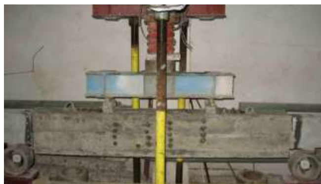
Рис. 2.19. Зразок після демонтажу опалубки
