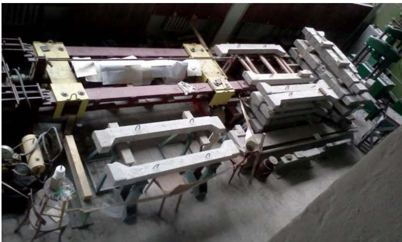
Рис.2.21. Загальний вигляд стенда для випробування разом з дослідними зразками
