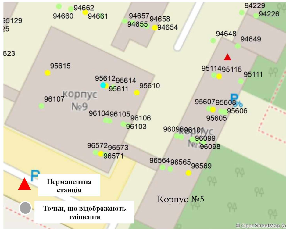
Рис. 3.36. Розміщення постійних стабільних відбивачів радіолокаційного сигналу на будівлі (м. Івано-Франківськ, корпус № 5 ІФНТУНГ)
