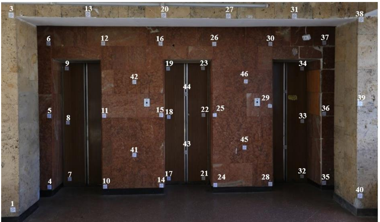
Рис. 2.13 Просторовий калібрувальний тестовий полігон
