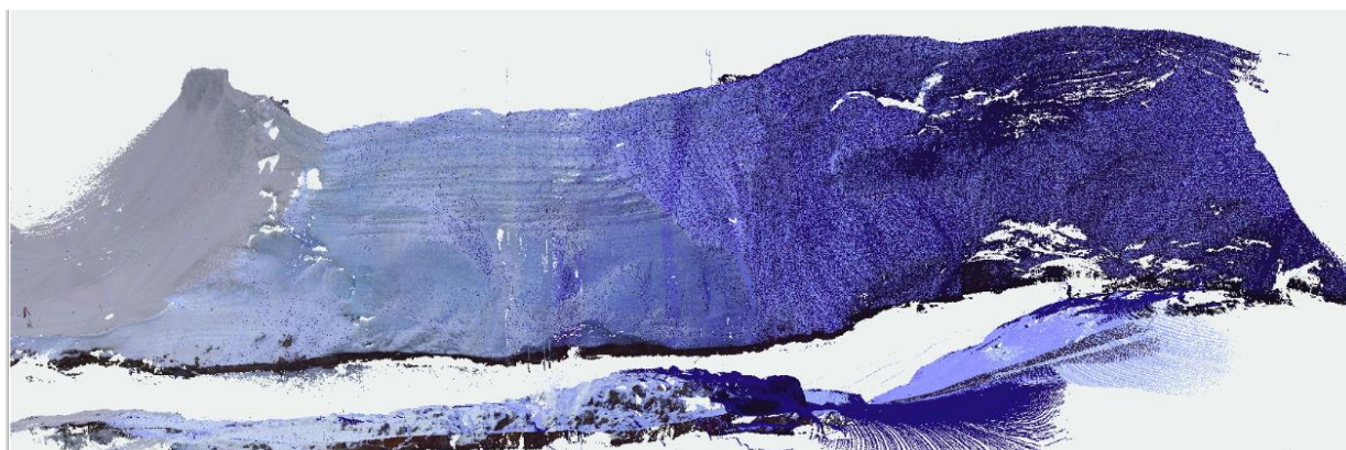
Рис. 2. Точкова модель південної частини льодовика о. Галіндез (2018 р.)
