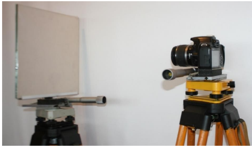
Рис. 2.8 Визначення фокусної віддалі ЦЗК
