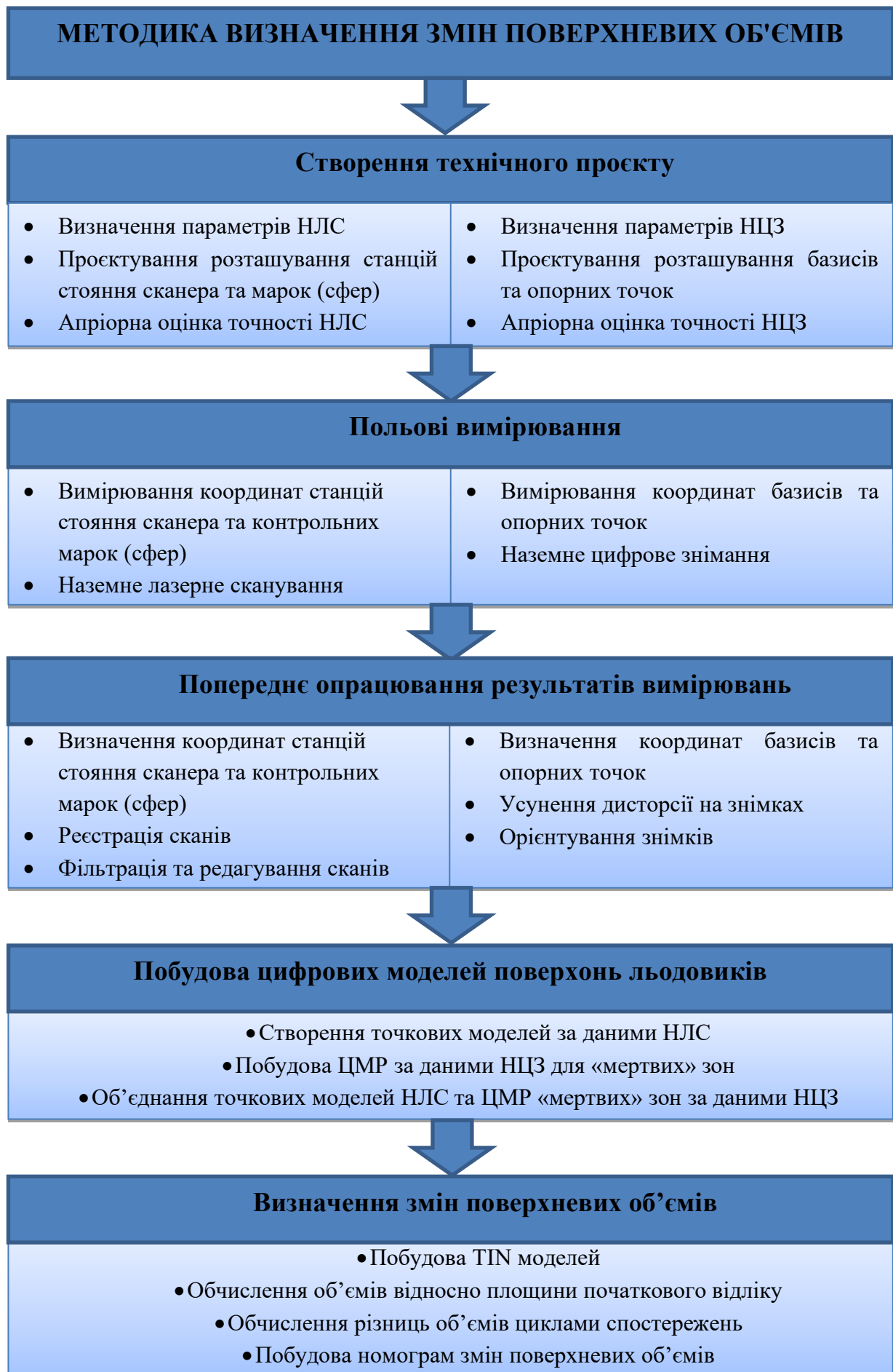
Рис. 3.1 Технологічна схема методики комплексного дослідження
