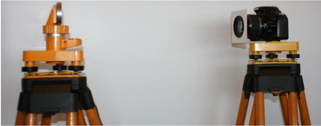
Рис. 2.3 Визначення фокусної віддалі
