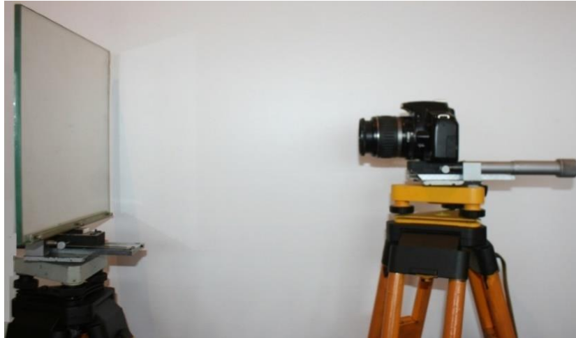
Рис. 2.11 Визначення фокусної віддалі ЦЗК
