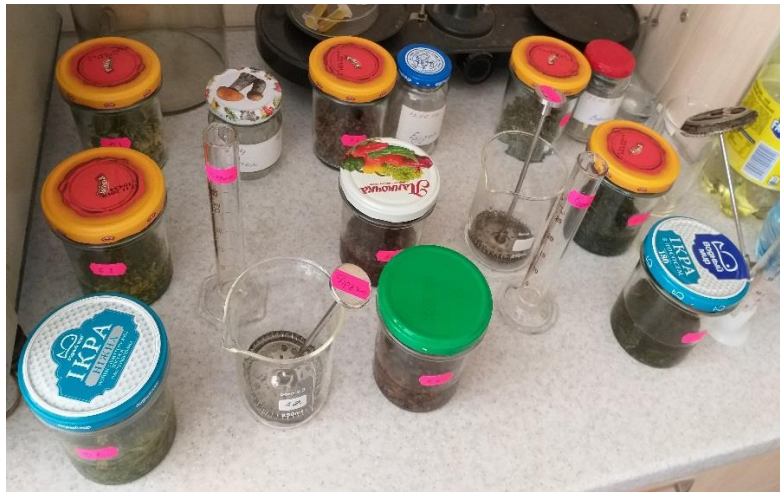
Рис. 1.17. Одержання екстрактів методом перколяції в лабораторних умовах
