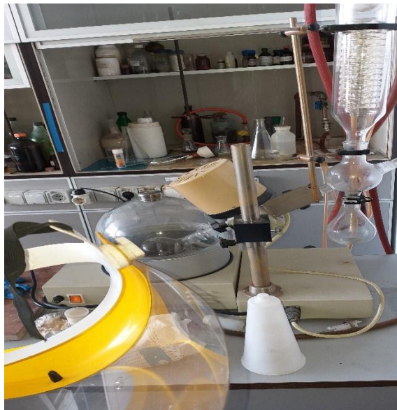
Рис. 1.13. Лабораторна роторна випарна установка для концентрування екстрактів.
