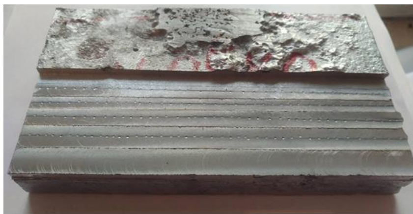
Рис. 3.21. Контроль однорідності поверхневого шару заготовки методом LM-твердості
