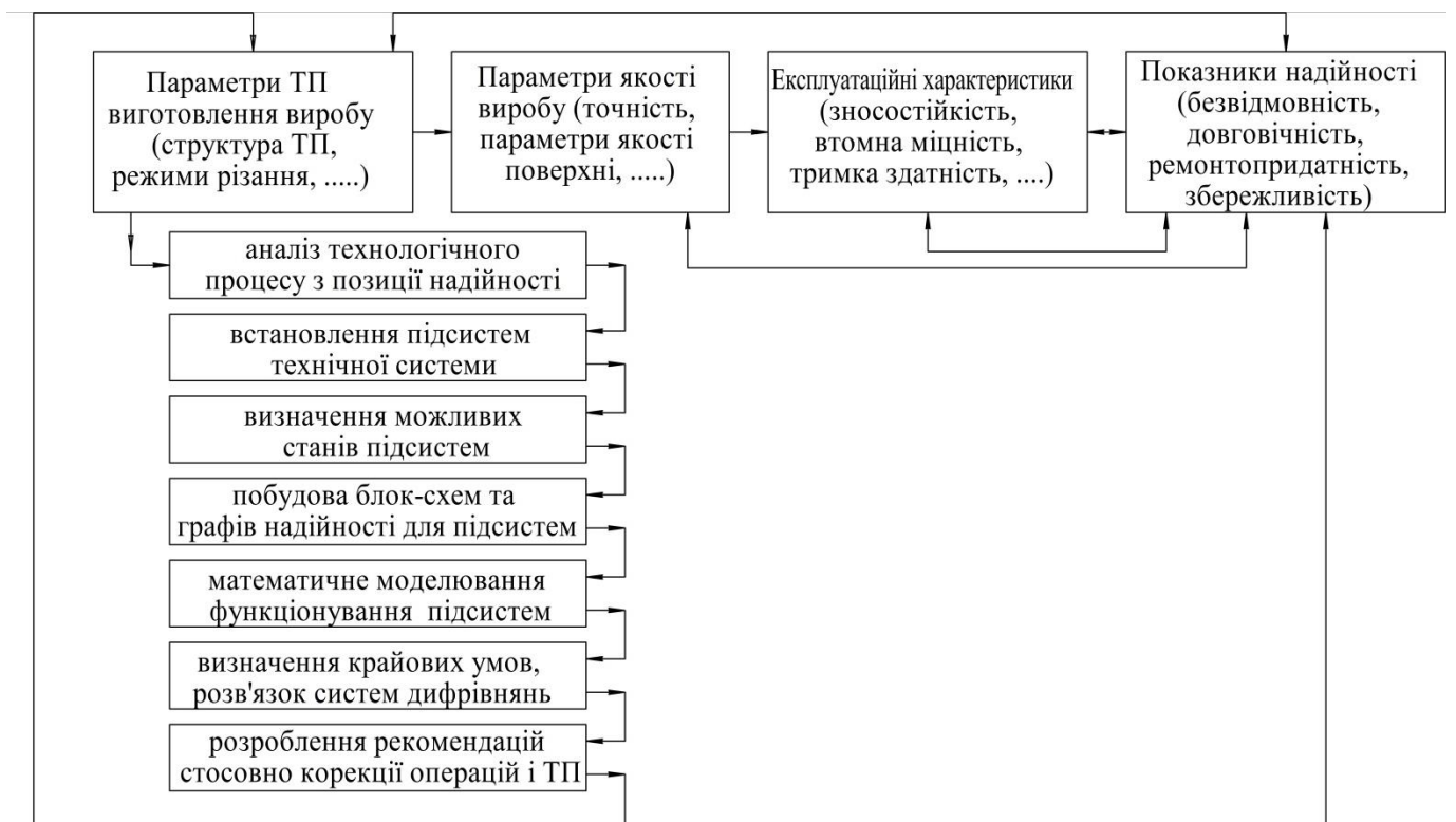
Рис. 2.2. Блок-схема взаємозв'язків забезпечення регламентованих параметрів якості машинобудівних виробів за умови недосягнення граничного стану металорізальним верстатом, верстатним пристроєм і металорізальними інструментами при обробленні виробу із врахуванням показників надійності підсистем технічної системи
