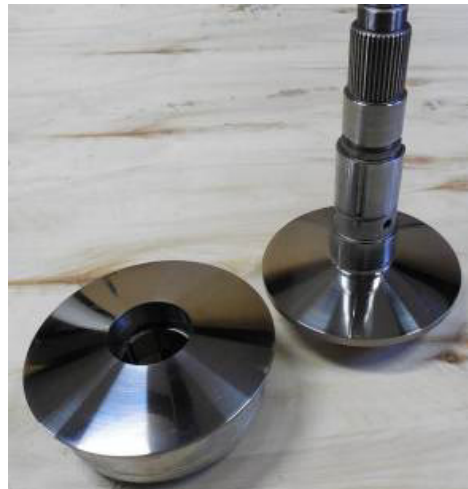
Рисунок 1.3 – Конічні диски варіаторних трансмісій із торцевими поверхнями деталей класу «тіла обертання»
