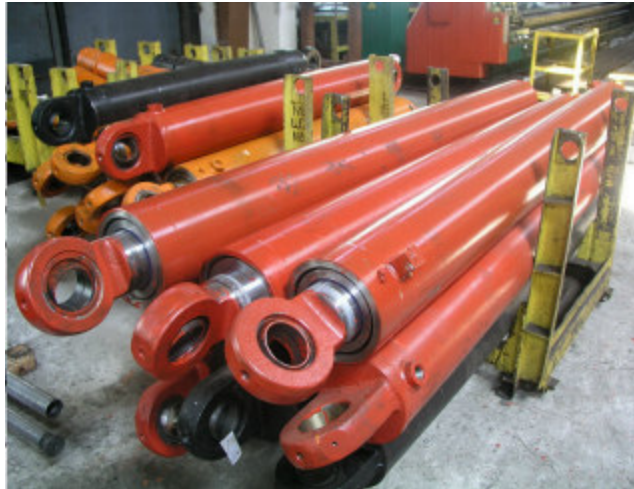
Рисунок 1.1 – Гідроциліндр плунжерний КС-4574.63.900-03.00 телескопування стріли автомобільного крана виробництва “ДЗАК” [28]
