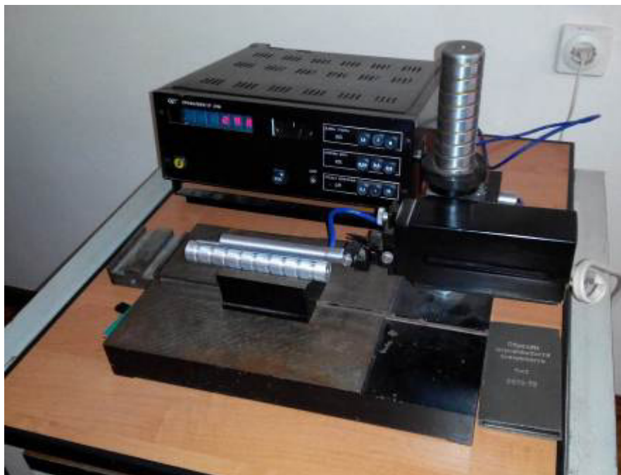
Рисунок 2.14 – Визначення параметрів шорсткості на профілометрі моделі 296
