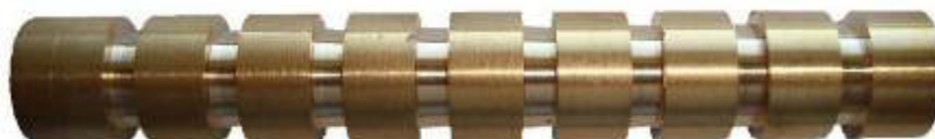
Рисунок 2.15 – Креслення та загальні вигляди дослідних зразків для дослідження впливу подачі на шорсткість обробленої циліндричної поверхні
