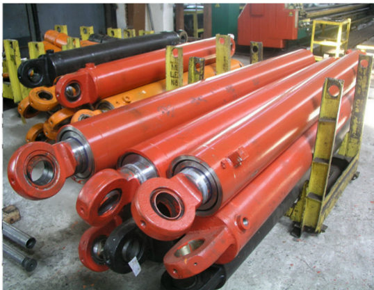
Рисунок 1. Гідроциліндр плунжерний КС-4574.63.900-03.00 телескопування стріли автомобільного крана виробництва «ДЗАК»
