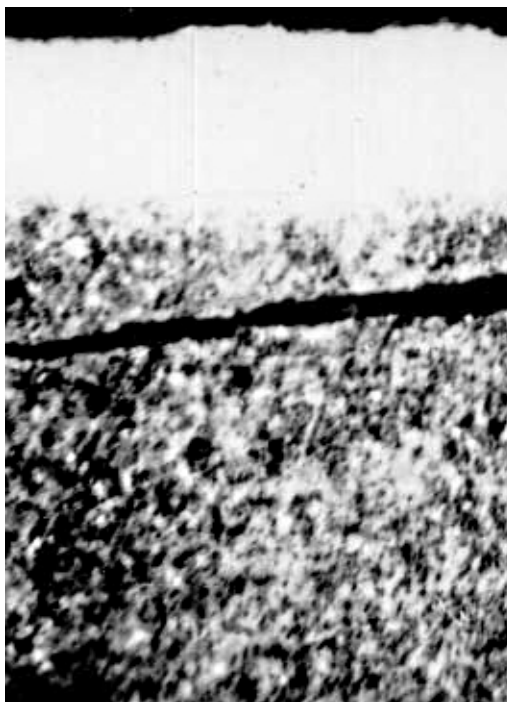
Рисунок 6.21 – Фото розповсюдження тріщини під час досліджень на контактну втомну міцність
