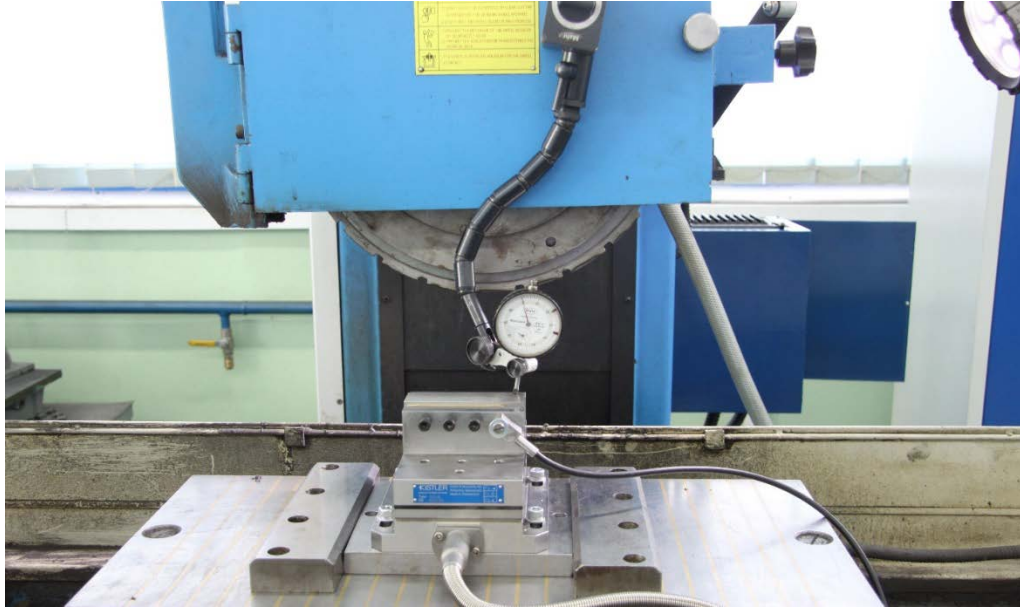
Рисунок 2.16 – Перевірка точності встановлення зразка у динамометрі
