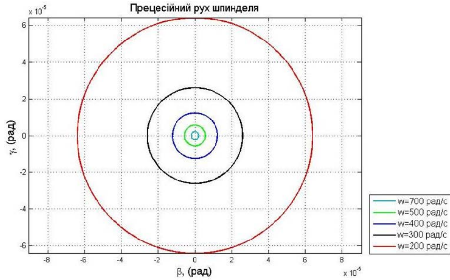
Рисунок 4.60 – Прецесійний рух шпинделя у холостому ході без навантаження
