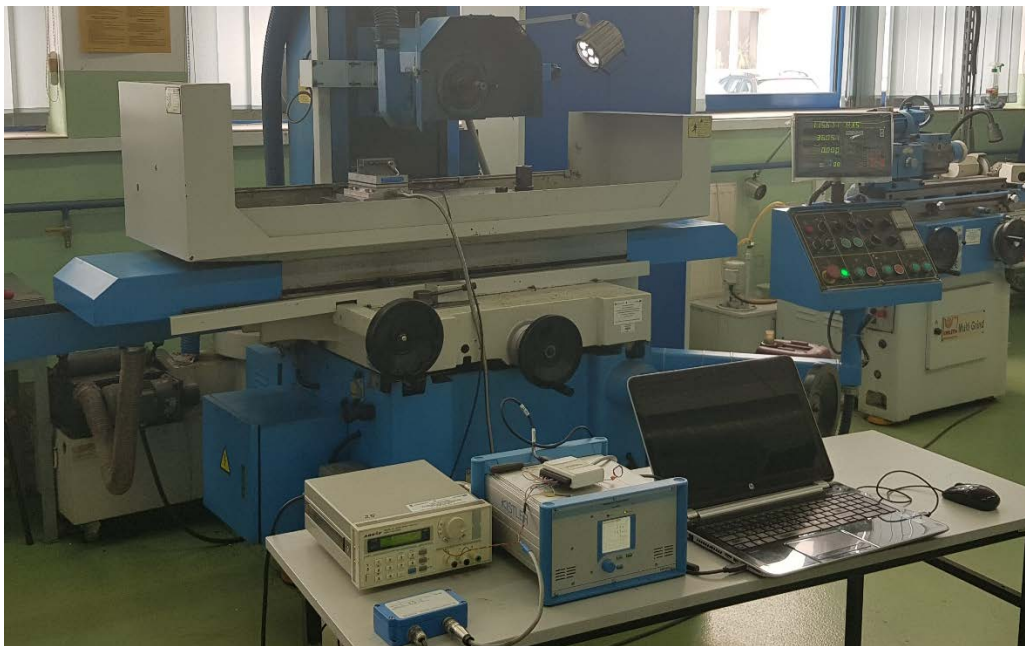
Рисунок 4.12 – Набір фірми Kistler (Швейцарія) для вимірювання складових сили при обробленні (а); трикомпонентний динамометр типу 9257В (б)
