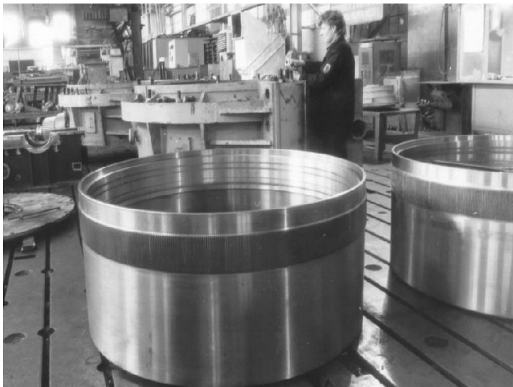
Рисунок А.2 Виробництво великогабаритних хвильових зубчастих редукторів на ПрАТ «НКМЗ»
